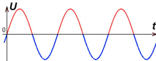
В переменном электрическом токе можно условно выделить положительные и отрицательные полупериоды. Всё то, что больше нулевого значения относится к положительным полупериодам (положительная полуволна – красным цветом), а всё, что меньше (ниже) нулевого значения – к отрицательным полупериодам (отрицательная полуволна – синим цветом).
