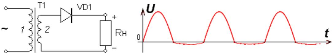
Из рисунка видно, что диод отсекает отрицательную полуволну. Если мы перевернём диод, поменяв его выводы – анод и катод местами, то на выходе окажется, что отсечена не отрицательная, а положительная полуволна.
