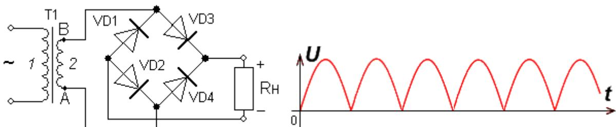
Если ток вторичной обмотки трансформатора течёт по направлению от точки «A» к точке «B», то далее от точки «B» ток течёт через диод VD3 (диод VD1 его не пропускает), нагрузку  $R_h$ , диод VD2 и возвращается в обмотку трансформатора через точку «A». Когда направление тока вторичной обмотки трансформатора меняется на противоположное, то вышедший из точки «A», ток течёт через диод VD4, нагрузку  $R_h$ , диод VD1 и возвращается в обмотку трансформатора через точку «B».
