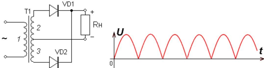
По своей сути это два однополупериодных выпрямителя, подключенных параллельно в противофазе, при этом начало второй обмотки соединено с концом первой вторичной обмотки. Если в мостовой схеме во время действия обоих полупериодов сетевого напряжения используется одна вторичная обмотка трансформатора, то в балансной схеме две вторичных обмотки (2 и 3) используются поочерёдно.
